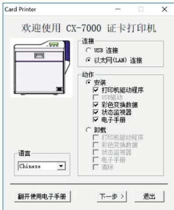
**5 选择卡片打印机设置屏幕上的 [打印机驱动程序]复选框**
