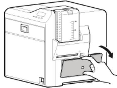
**3** 用真空吸尘器去除风扇滤网所粘的尘垢
