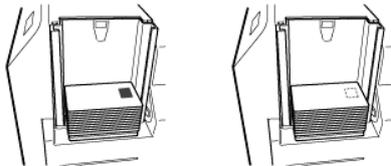
4 安装送卡箱外盖，把送卡箱的旋钮设置在 [LOCK]上
