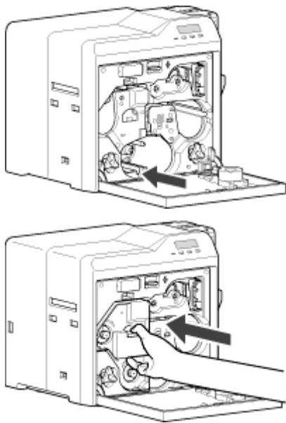
6 インクリボンカセットをガイドレールに沿って「カチッ」と音がするまで挿入し、プリンタードアを閉める
