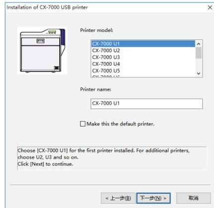
① 根据打印机的组件编号选择 [Printer model] "组件编号设置" (第 28 页)
