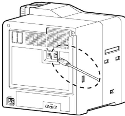
3 LAN ケーブルをコンピューターが接続しているネットワーク上に設置されたハブの接続端子に差し込む
